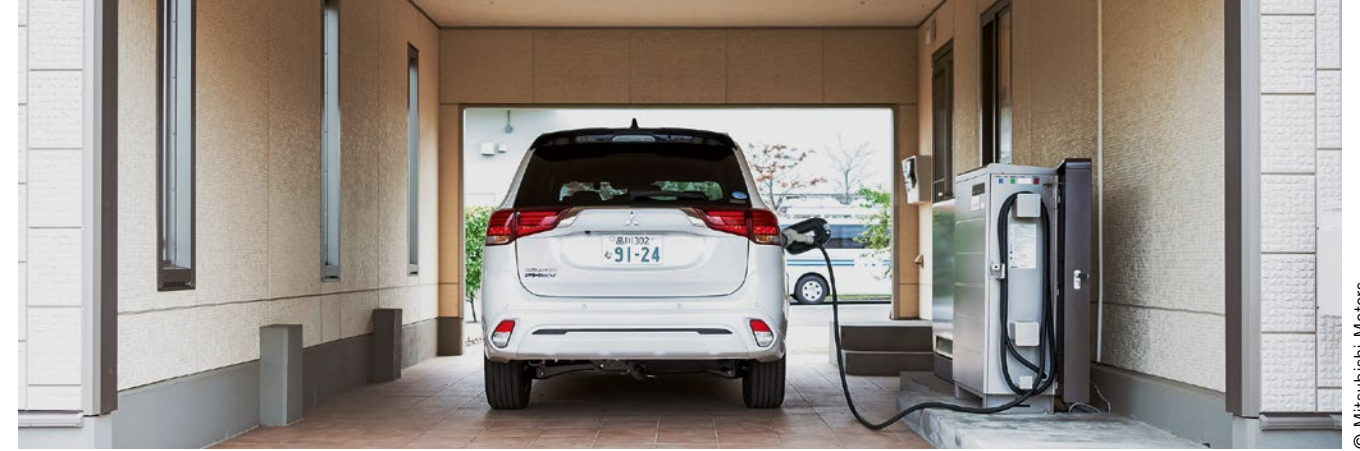
Der Mitsubishi Outlander PHEV eignet sich als eines von wenigen Modellen bereits für bidirektionales Laden
